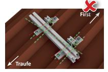
Trapez 4 immer mittig auf der Hochsicke montieren, dadurch verläuft die Tragschiene genau senkrecht zur Hochsicke.
