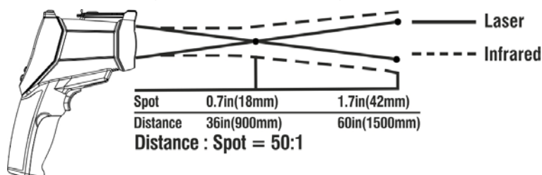
Abb. 27: Diameter der Oberfläche S gemäß dem Abstand vom Gegenstand D (in mm)
