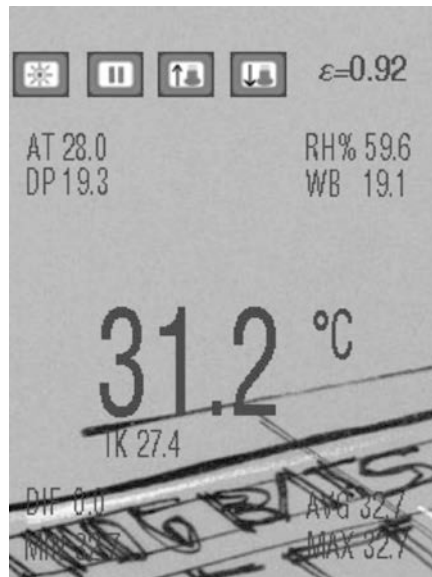
Abb. 26: IR-Temperaturmessung mit eingebildeten Photo-Kamera
