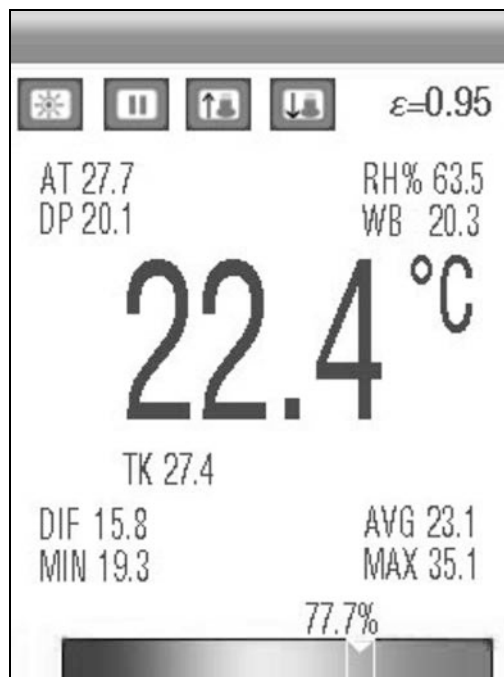
Abb. 30: Temperaturmessung des Taupunktes
