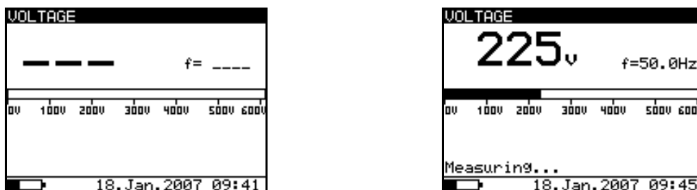
Abb. 9. Anzeigezustände der Funktion VOLTAGE (Spannung)
