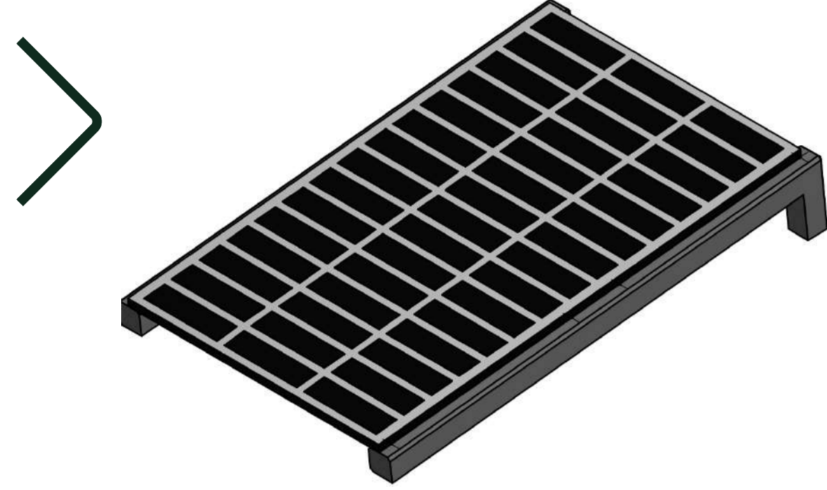
Einzelaufbau mit 2 x Betonsockeln
